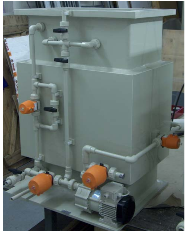
Elektrolytbehälter mit Pumpenverrohrung Kugelhähnen und Membranventilen Material PP
