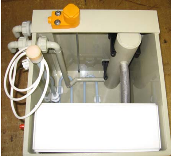
Elektrolyt- Vorlagebehälter mit Heizung und Niveauregelung Material PP
